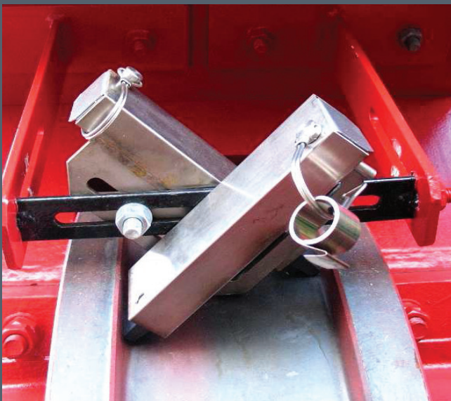
dMT-SPC® MSB產品：用在天車輪輪緣(Flange)
